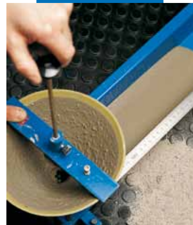
Messung der Fließfähigkeit nach UNI 13395-2
