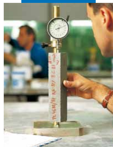
Messung der Expansion nach UNI 8147
